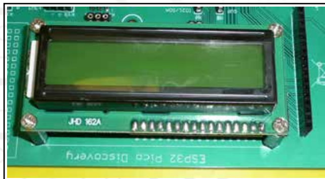
Abbildung 21 • Die endgültige Anbringung des LC-Displays.
