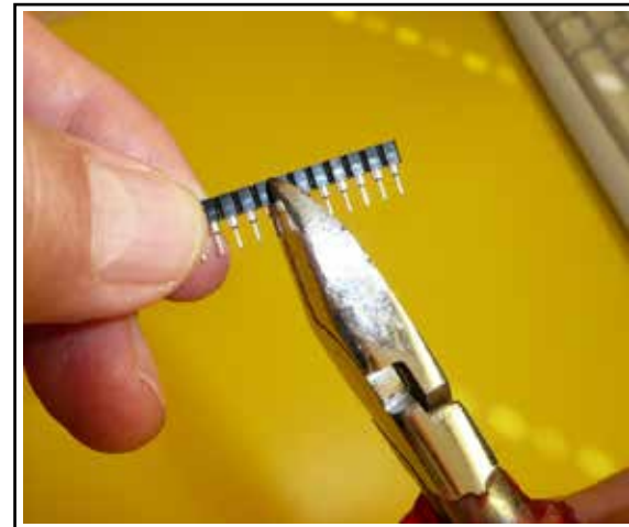
Abbildung 9 • Das Kürzen der flexiblen Buchsenleisten.
