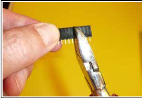
Abbildung 10 • Das Kürzen der starren Buchsenleiste mit einem Seitenschneider.
