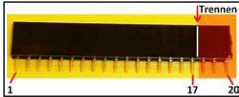
Abbildung 12 • Das Kürzen einer Buchsenleiste auf 17 Pins.
