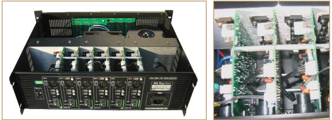
Bild 9: Klassische Gegentaktendstufe mit viel Aufwand für Schutzschaltungen.
